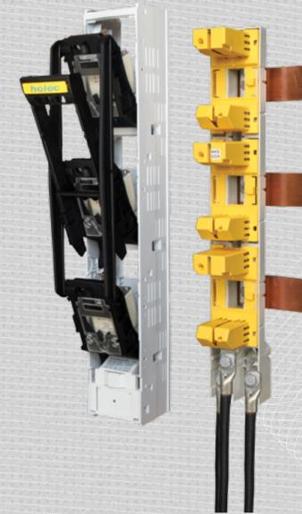
Compactas, permitem uma distribuição de energia elétrica concentrada num espaço reduzido. Possibilidade de saída dos cabos para cima ou para baixo por simples inversão. Fornecidas nas capacidades de 160, 250, 400, 630, 800 e 1250A. Com larguras de 50, 100 ou 200mm.
